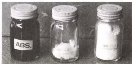
▲合成洗剤の主原料。石油工場のカスのアルキル・ベンゼン・スルホン酸塩(左)、化学工場の廃棄物の苛性ソーダ(中)、肥料工場の廃棄物の硫酸ソーダ(右)。(写真／本宮栄作さん提供)
